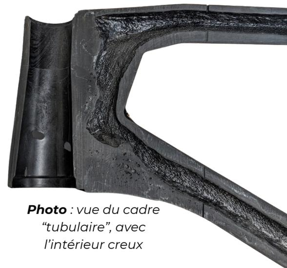
**Photo** : vue du cadre "tubulaire", avec l'intérieur creux
